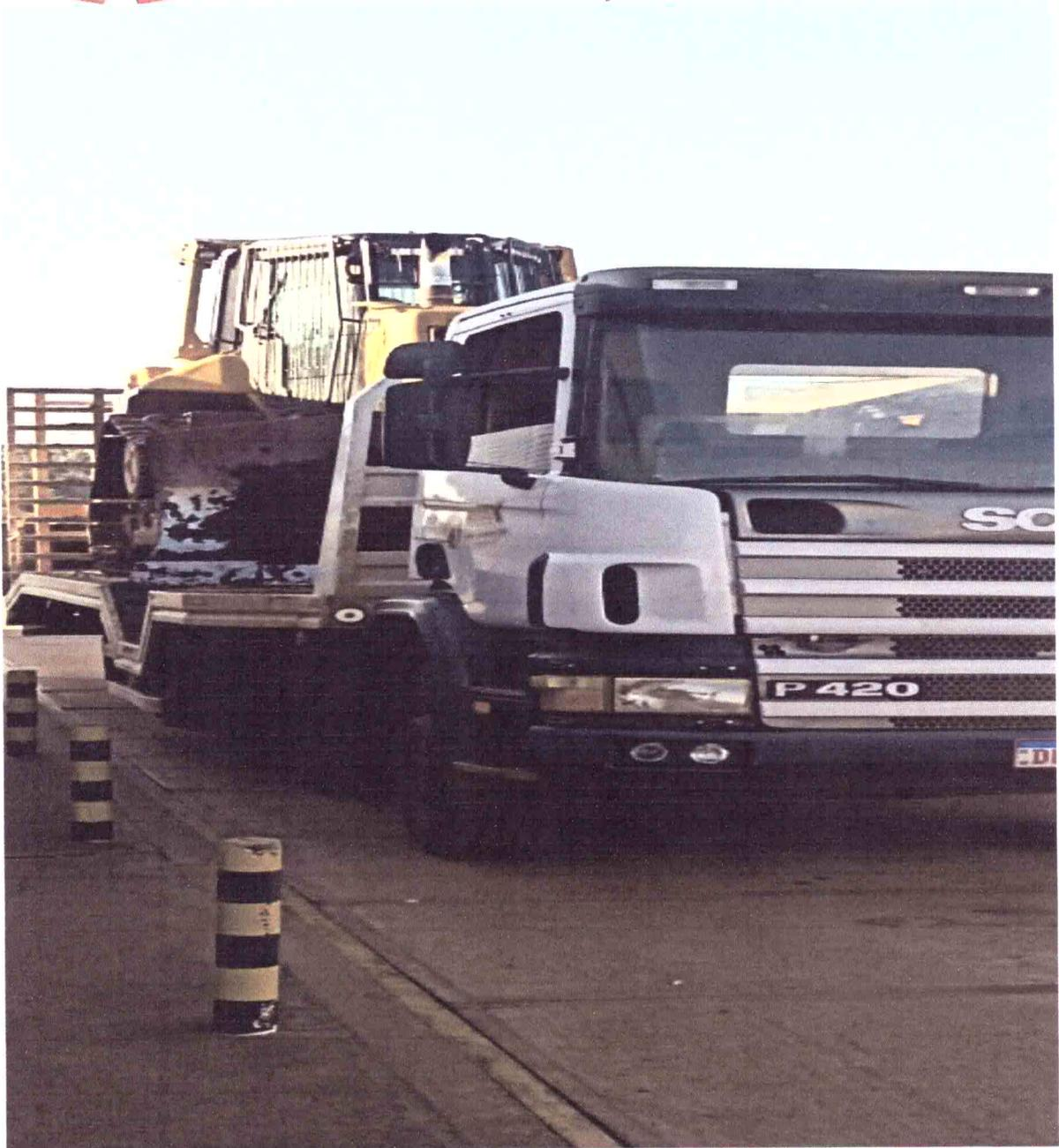
Sendo aferido o peso bruto do equipamento e caminhão, que resultou no peso total de 32.380 kg, conforme foto abaixo:
